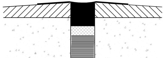
+ **Vertido de POLIBREAL y extendido  $\pm$  60 cm por cada lado de la junta.**
