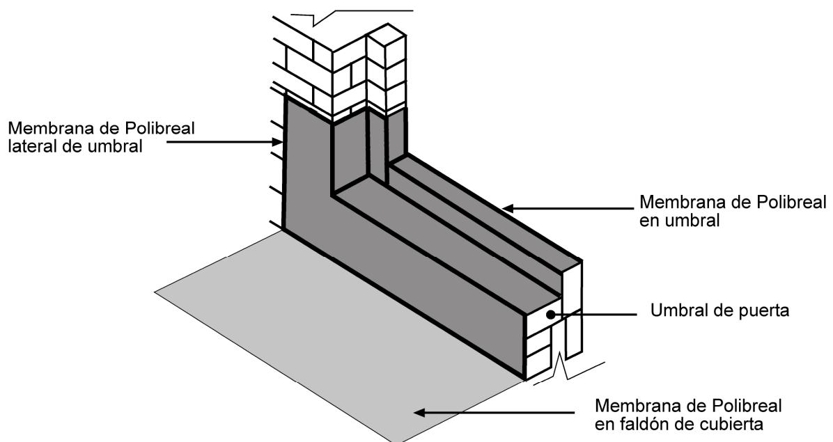
**La impermeabilización del umbral se realizará antes de colocar la carpintería.**
