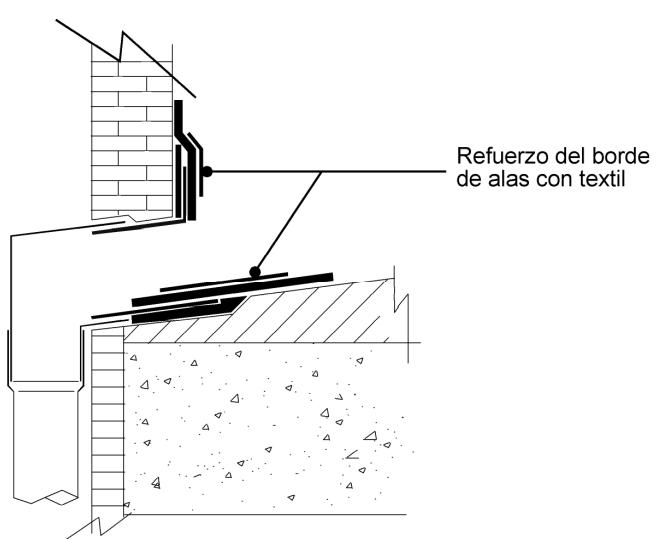
**5- La membrana impermeabilizante de POLIBREAL, prescrita para la cubierta, se prolongará sobre el tratamiento de sellado realizado.**
