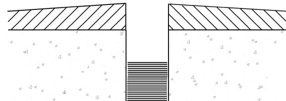
+ **Colocación de textil, una banda de  $\pm$  35 cm de anchura, centrada sobre la junta y totalmente adherida al POLIBREAL.**
